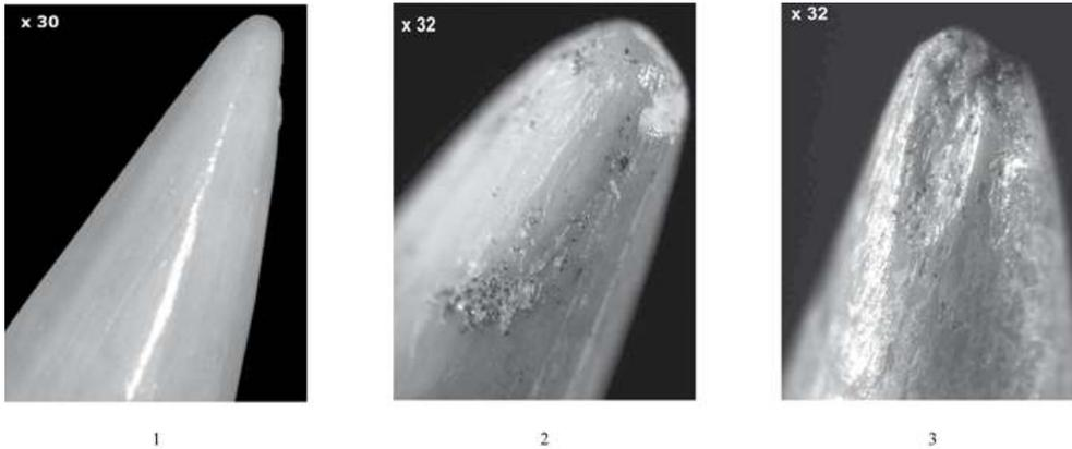
1 : Pointe peu déformée (x 30) ; 2 : Pointe déformée (x 32) ; 3 : Pointe très déformée (x 32).
